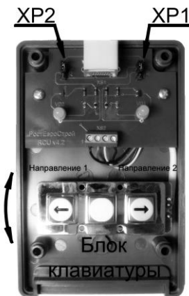
Вид пульта со снятой крышкой
