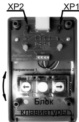
Вид пульта со снятой крышкой
