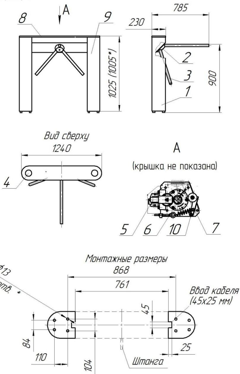
Габаритные и установочные размеры турникетов серии "Ростов-Дон ТТ10М1/КП1-Н" (размер 1005\* - для турникета с крышкой из нержавеющей стали)
